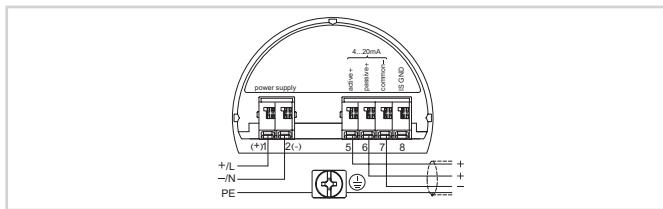
Отсек подключения (двухкамерный корпус)
